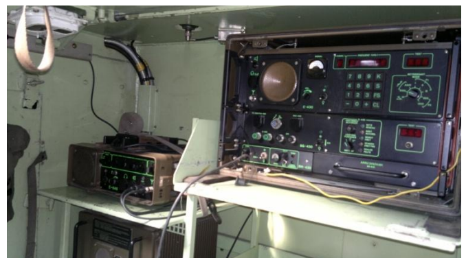
l'unité émettrice ( SE-430 ) dans le char de transmission M113
