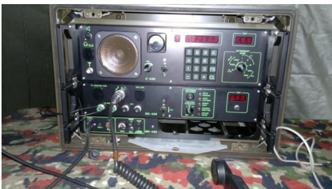
Face avant de la radio militaire SE-430 L'unité de commande à l'extérieur
